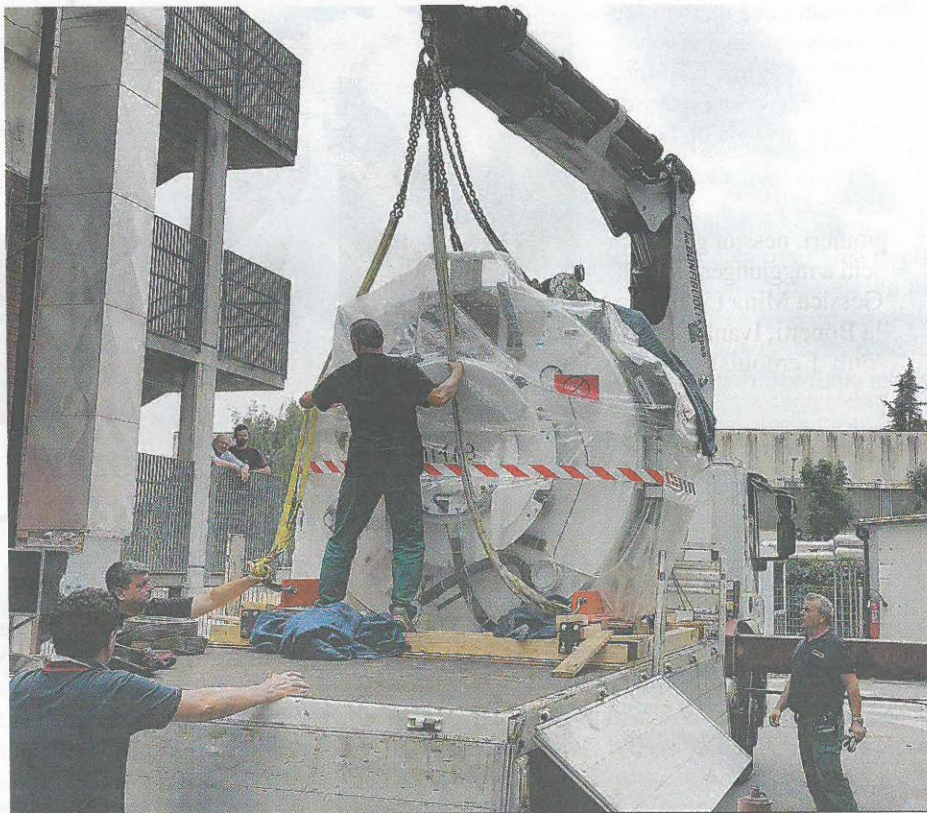
Qui e sotto, le difficili operazioni di scarico: la macchina pesa 5,4 tonnellate
